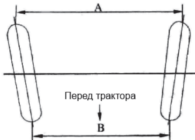
Рис. 3.22. Развал-схождение. Трактор. Вид сверху.
