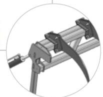
Рамка-толкатель защищает трактор и помогает в валке деревьев
