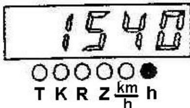
Появление на входе индикатора импульсов от датчиков скорости приводит к переходу в режим индикации скорости движения. При этом на цифровой индикатор выводится измеренное расчетное значение скорости и загорается светодиод, расположенный рядом с символом «km/h».
